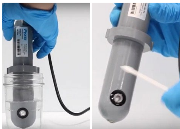
Figura 19. Limpieza del sensor de la serie HM-500 Limpieza del sensor de la serie HM-500
